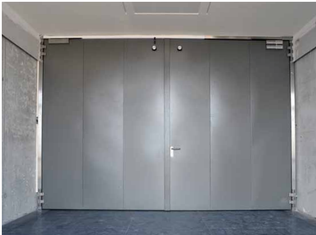
Porta Magnum REI 120 a due ante, cerniere e chiudiporta aerei in acciaio inox, elettromagneti, lato tirare. Magnum two leaves, stainless steel hinges and door closers, electromagnets, pull side.
